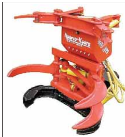
Abbildung 2: Energieholz-Sammelaggregate Bracke C16.a (links) und NaarvaGrip 1500-40e (rechts)
